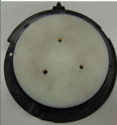
*Positionieren der Gewindebohrungen im Endanschlagadapter über den neu gesetzten Durchgangsbohrungen im Original Endanschlag.*
