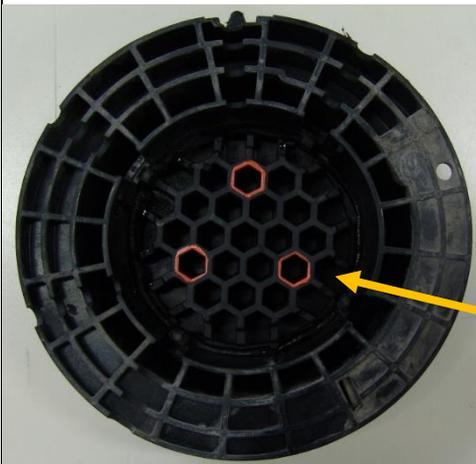
*Die serienmäßigen Endanschläge sind rückseitig, entsprechend der Gewinde im mitgelieferten Endanschlagadapter, zu durchbohren.*
